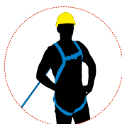
Ancrage au niveau du dos
